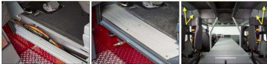
[Interior Cab Wire Raceways]
